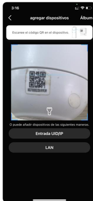
O puede ingresar manualmente el UID de la cámara para agregar el dispositivo. El UID de la cámara consta de 16 dígitos que comienzan con 9527000xxxxxxx.
