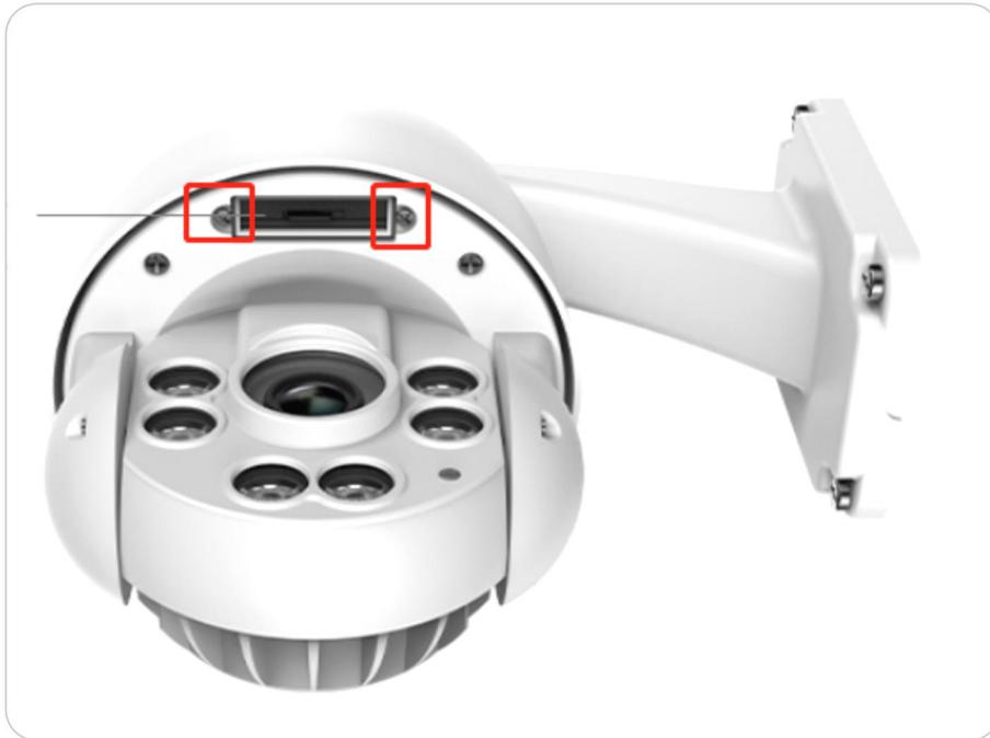
Paso 2. Inserte la tarjeta micro SD tal como se muestra en la imagen a continuación, use la uña (o use la aguja de reinicio provista) para empujar la tarjeta micro SD hasta que quede bloqueada, y escuchará un clic y la tarjeta micro SD. no saldrá si se inserta correctamente.
