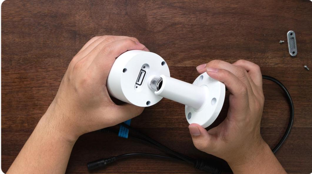
Paso 2. Inserte la tarjeta micro SD tal como se muestra en la imagen a continuación, use la uña (o use la aguja de reinicio provista) para empujar la tarjeta micro SD hasta que quede bloqueada, y escuchará un clic y la tarjeta micro SD. no saldrá si se inserta correctamente.
