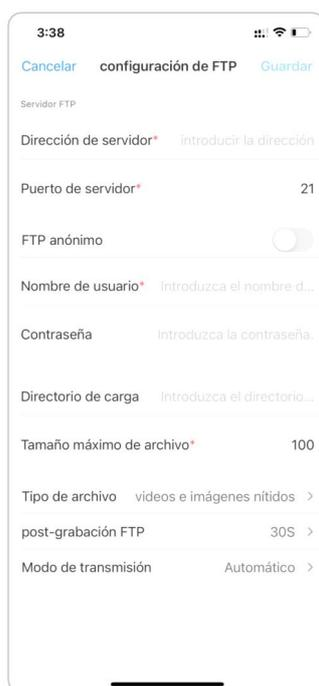
Dirección del servidor: Escriba la dirección de su servidor FTP y Puerto FTP. El puerto FTP predeterminado para los productos Reolink es 21.
