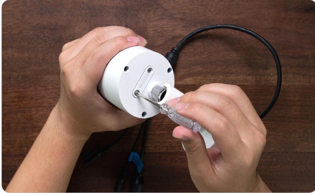
2. Busque la ranura de la tarjeta micro SD y use algo afilado como el pin de reinicio o un clip o la uña para empujar la tarjeta SD y hacer que salga.
