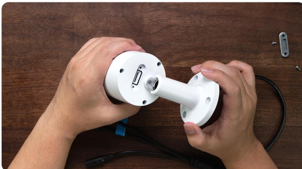
3. Inserte la tarjeta micro SD como se muestra en la imagen a continuación, use la uña (o use la aguja de reinicio provista) para empujar la tarjeta micro SD hasta que quede bloqueada, y escuchará un clic y el micro La tarjeta SD no saldrá si se inserta correctamente.
