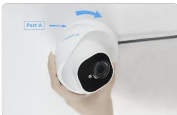
Étape 4. Une fois la caméra installée, vous pouvez ajuster l'angle de 70 degrés vers le haut et vers le bas ou de 360 degrés horizontalement.
